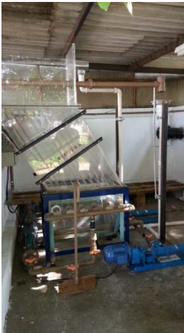
Figura 2: Fotos da unidade piloto de decantação lamelar
